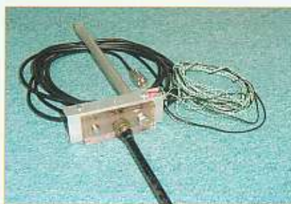
Een zelfgemaakte isolator van plexiglas waarop een spriet uit de dump is geschroefd. De gemonteerde grondpen maakt het mogelijk de spriet stevig in de grond te plaatsen waarna de radialen kunnen worden uitgerold.
